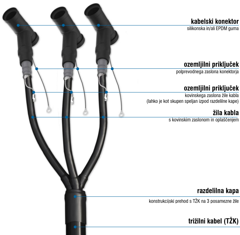
Slika 5: Primer izvedbe kablanskih konektorjev na trižilnem kablju (grafično obdelan; vir Ensto).
